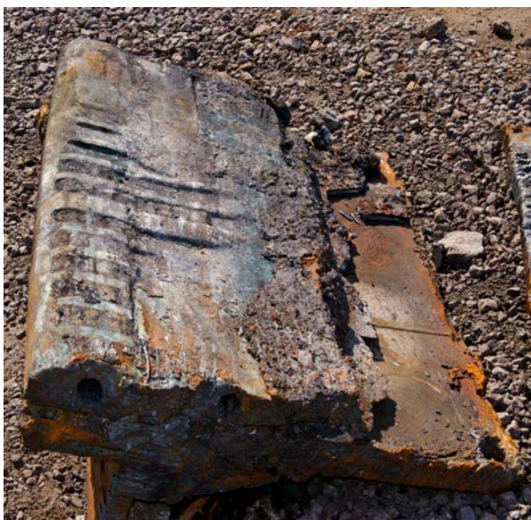
Рис. №4. Вышедшие из строя медные холодильники ряда 6
