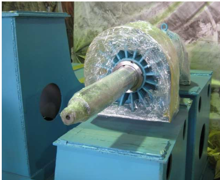
Figura 4. Blocos de rolamentos de fabrico especial para ventilador resistente ao calor destinados para o forno que efetua homogeneização de produtos de alumínio
