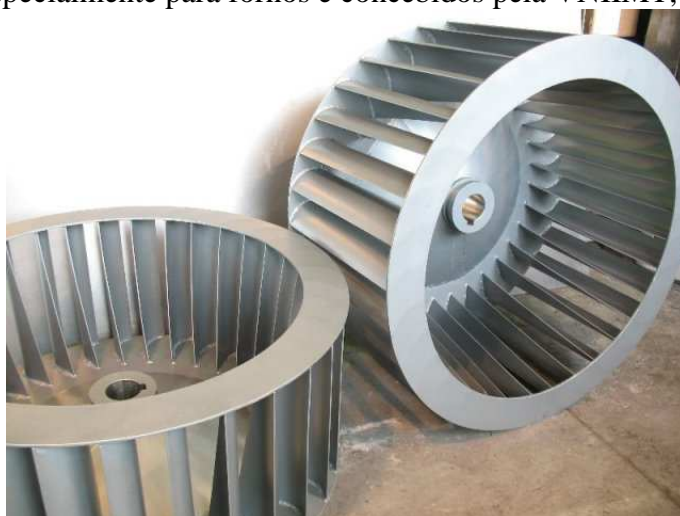
Figura 3. Rodas de aletas resistentes ao calor (e a altas temperaturas) para ventiladores de forno concebidos pelo VNIIMT
