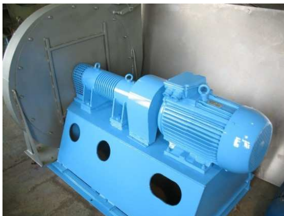
Figura 9. Aspirador de fumo não estandardizado quimicamente resistente especialmente concebido pelo VNIIMT
