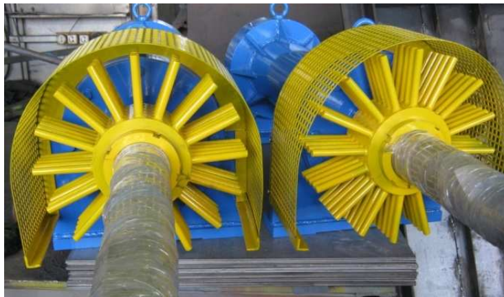
Figura 5. Carcaça do ventilador resistente ao calor em conjunto com um bloco de rolamentos de fabrico especial destinados para o forno vertical de têmpera
