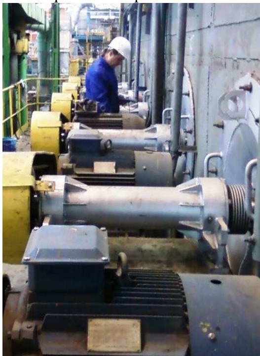
Figura 1. Ventiladores resistentes ao calor para fornos concebidos pelo VNIIMT
