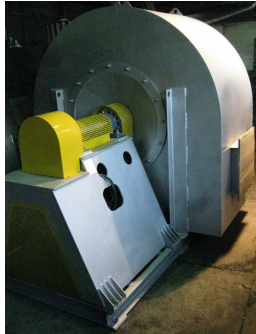
Figura 7,8. Ventilador resistente a altas temperaturas e a carcaça espiral calorífuga
