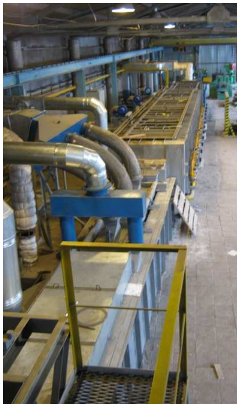
Рис. 12. Печной агрегат и охладители для регулирования температуры расплава свинца закалочной ванны
