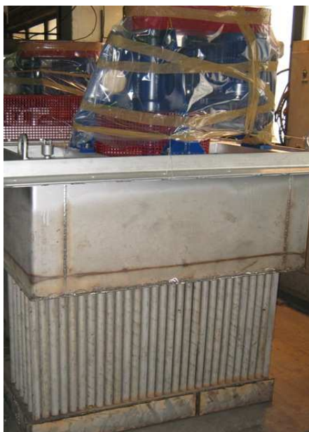
Рис. 8. Циркуляционный нагреватель закрытого типа в сборе с жаропрочным вентилятором
