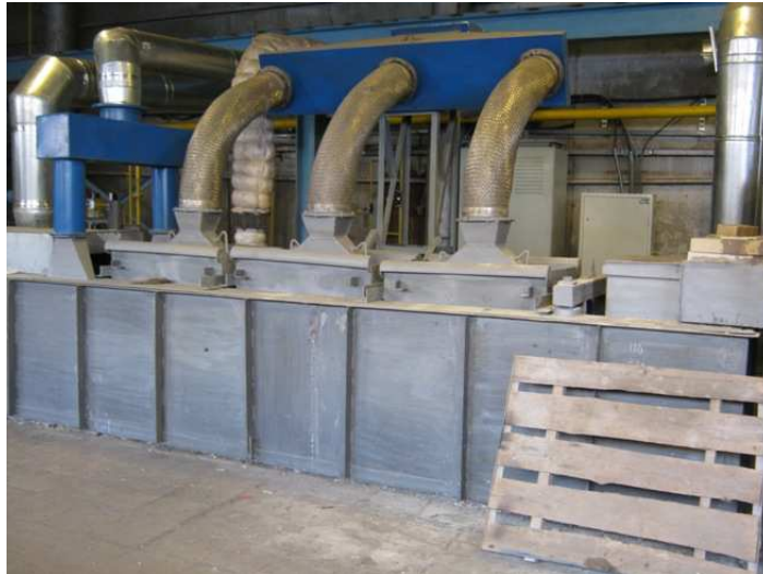
Рис. 11. Охладители для регулирования температуры расплава свинца закалочной ванны
