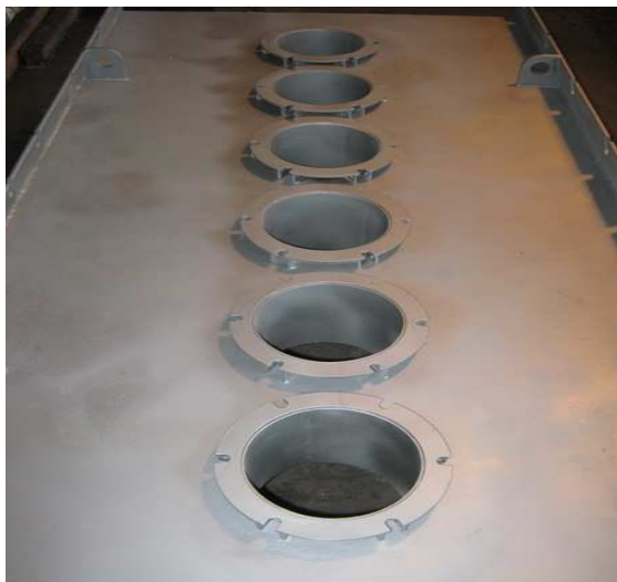
Рис. 2. Центральная секция вакуумирования лифтовых (ТЛТ) труб
