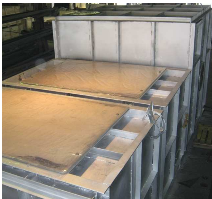
Рис.7. Фланцы для размещения двух циркуляционных нагревателей закрытого типа
