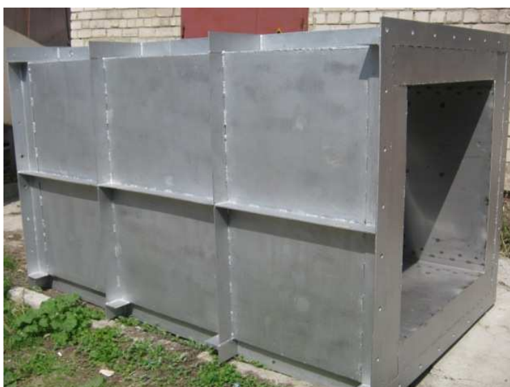
Рис. 5. Подводящий канал теплоносителя
