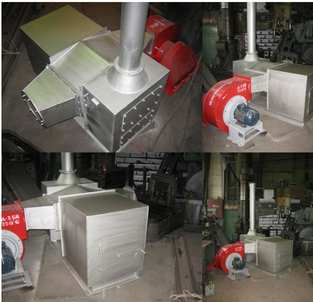
Малогабаритный твердотопливный теплогенератор для воздушных систем отопления конструкции ОАО ВНИИМТ, мощностью 50кВт
