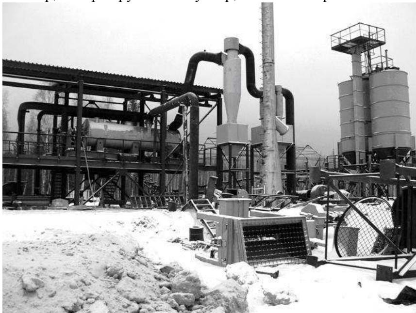
Рис. 3 Установка для сушки кварцевого песка 12 т/ч
