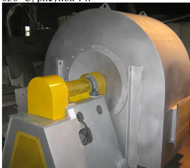
Рисунок 14 – Общий вид высокотемпературного вентилятора термической печи
