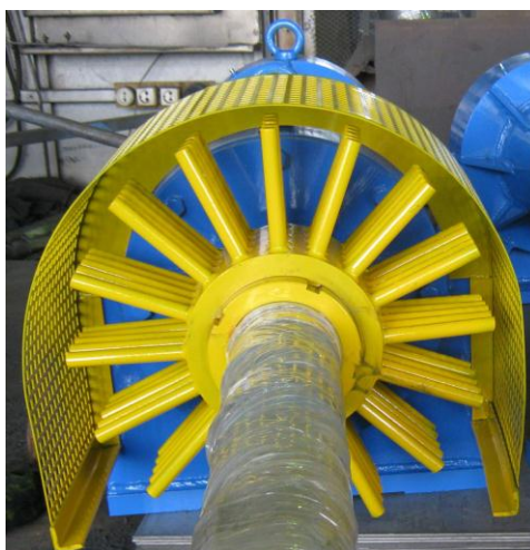
Рисунок 13 – Применение устройств охлаждения стержневого типа
