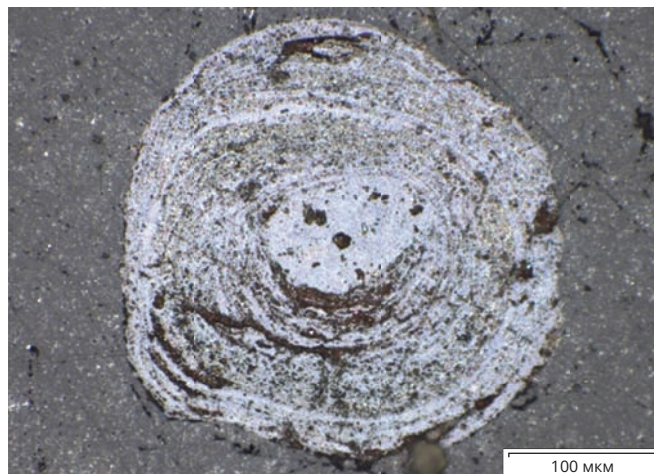
Крупный концентрически зональный агрегат оксидов железа, сложенный из множества тончайших слоев гематита, магнетита и гетита
