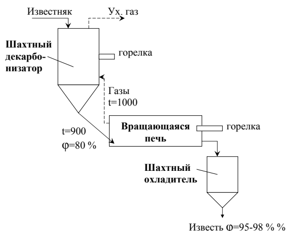
Схема комбинированной установки для получения высококачественной извести
